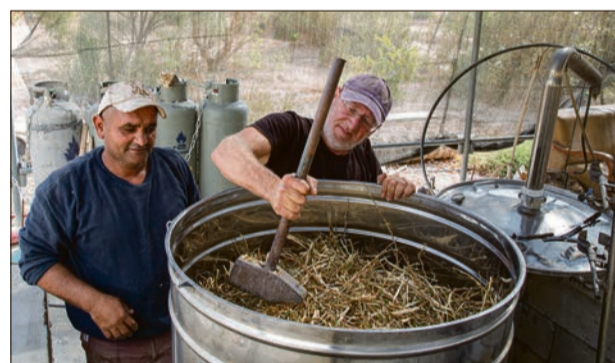
Rührend: Guy Erlich und sein beduinischer Mitarbeiter Chaled füllen den Destillierkessel mit den Ästen des »Balsam von Gilead«, um ätherisches Öl zu gewinnen.
